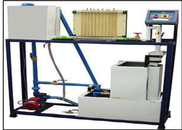
Venture Orifice Meter
